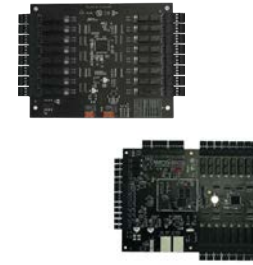
Panel de control de elevadores
